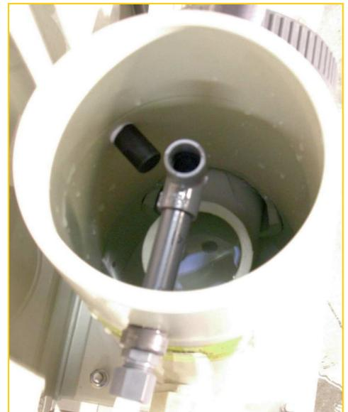
**ATTENTION :** En cas d'écoulement par l'embout de fuite l'installation doit être mise à l'arrêt rapidement pour éviter toute introduction de liquide dans le moteur
